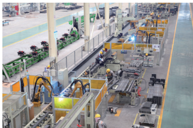
后端梁智能化柔性焊接生产线
