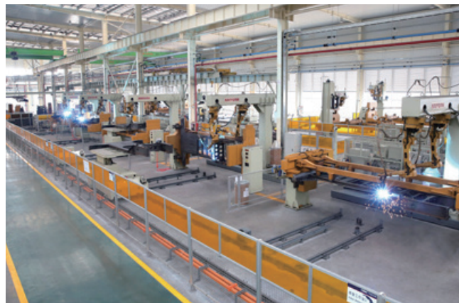
前车架智能化柔性焊接生产线
