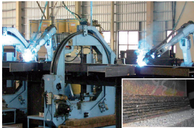
十字柱机器人焊接系统
